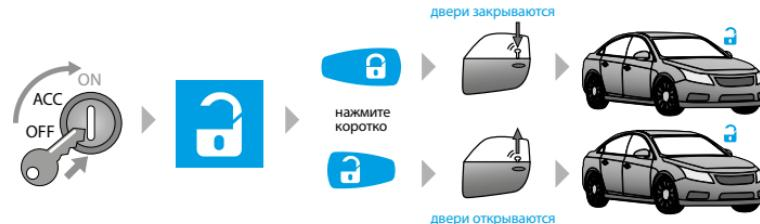
выключении зажигания сразу. В настройках предусмотрена возможность запрета отпирания дверей при выключении зажигания.
